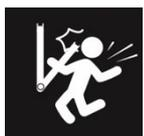
*INSTRUCCIONES IMPORTANTES PARA LA SEGURIDAD. El sistema dispone de potentes resortes en el interior que, en caso de una instalación en malas condiciones, pueden causar una apertura brusca del toldo. Si se observa alguna anomalía durante las maniobras de apertura y/o cierre, avisar a un profesional instalador. No permitir a los niños jugar con el toldo para evitar posibles daños.*
